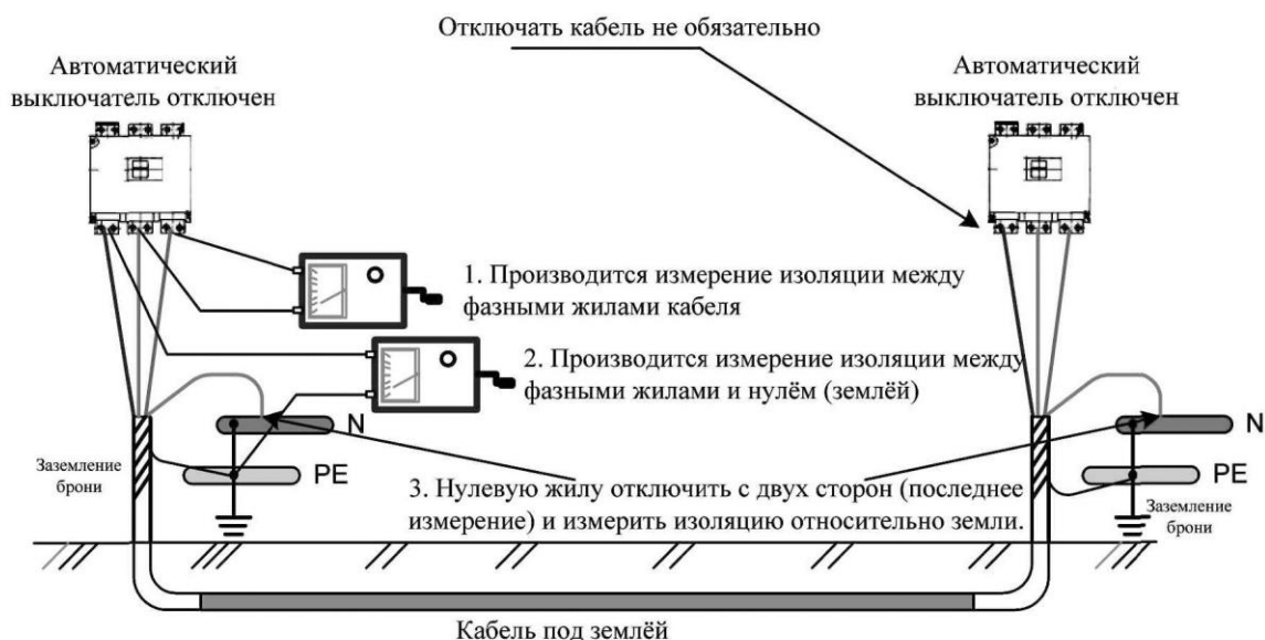
Рис.1. Схема для измерения сопротивления изоляции силовых кабельных линий.
